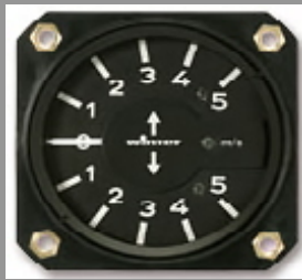
Variometer zeigt Steigen / Sinken in meter / Sekunden
